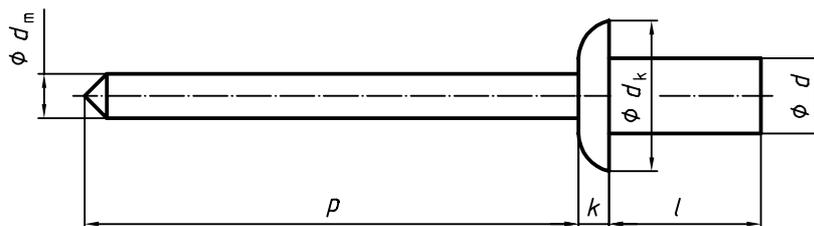
Figure 1 — Dimensions du rivet
