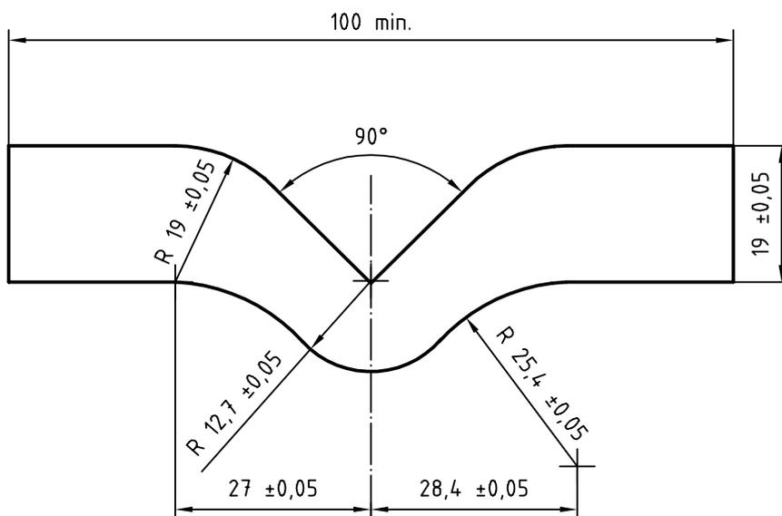
Figure 2 — Emporte-pièce pour éprouvette angulaire
