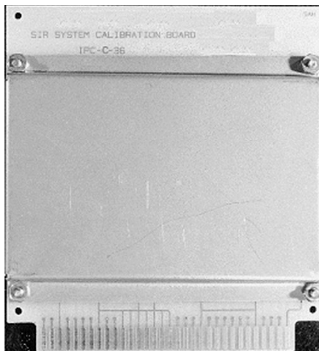
Figure 3 — Carte de vérification d'une résistance, avec son couvercle de protection
