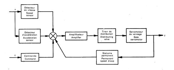
Fig. 3. — Régulateur accélérotachymétrique.
