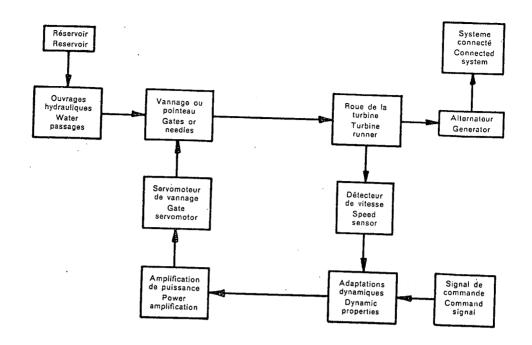
Fig. 1. — Schéma de principe du système réglé et du régulateur.
