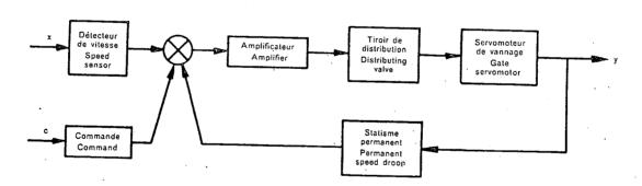
Fig. 2. — Régulateur de type tachymétrique.
