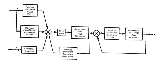
Fig. 5. — Régulateur accélérotachymétrique avec servomoteur pilote.
