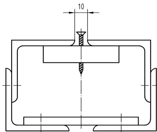
**Bild 1 — Prinzip der Prüfung des Oberflächen-Schraubenauszieh Widerstands an Platten mit < 15 mm Dicke**
