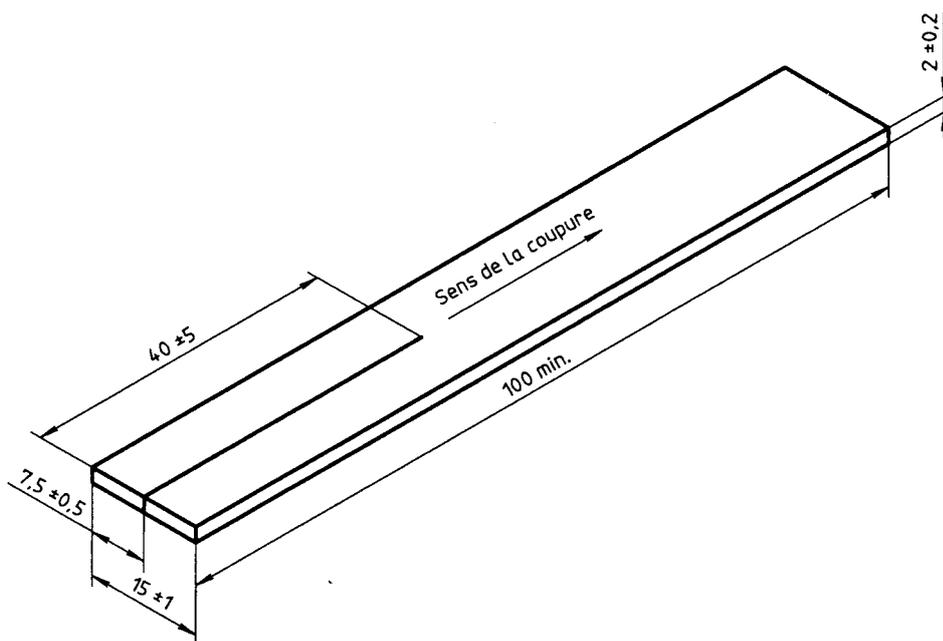
Figure 1 — Emporte-pièce pour éprouvette pantalon
