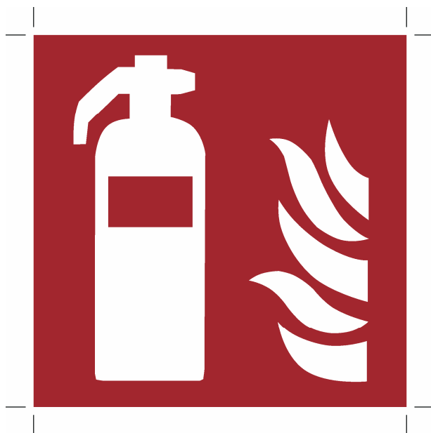
Figure 6 — Extincteur incendie (ISO 7010, F001)
