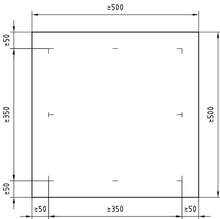
**Figure 1 — Marquage d'éprouvettes d'étoffe**
