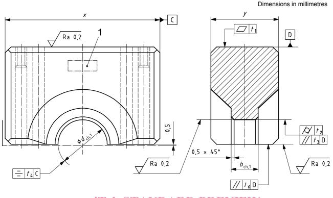
$x \ge 160 \text{ minTeh STANDARD PREV} 170 \text{ m/m}$  $x \ge d_{\text{ch, 1}} + 90 \text{ m/m}$  (standards.iteh.ai)  $x \ge b_{\text{ch, 1}} + 5 \text{ m/m}$
