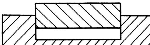
Figure 2 – Moule de type positif
