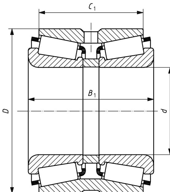
NOTE La bague extérieure d'un roulement à deux rangées peut être munie ou non de gorge et de trous de lubrification.
