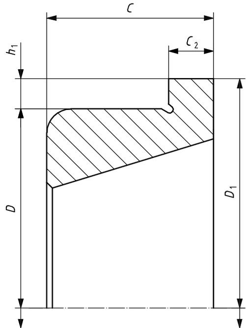
Figure 4 — Roulement à rouleaux coniques à une rangée avec bague extérieure à collet
