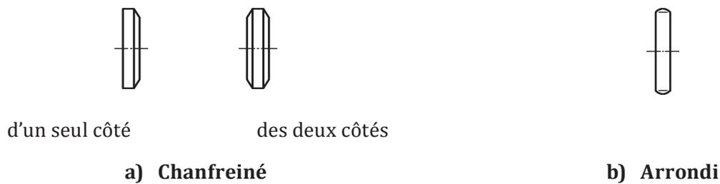
**Figure 5 — Profils des molettes de soudage**
