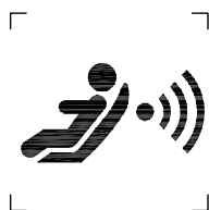
Рисунок 1— Символ для автоматической системы обнаружения присутствия и ориентации детского кресла (CPOD)
