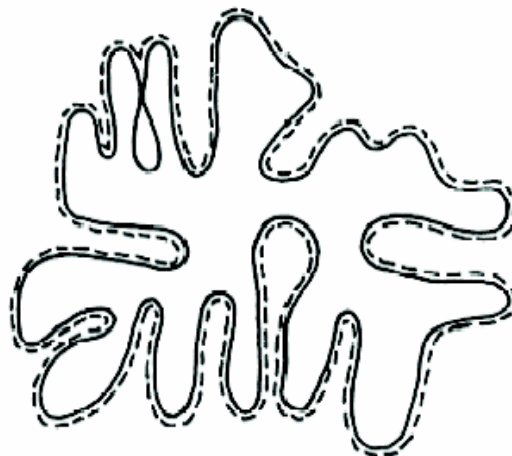
Рисунок 2 — Схематическое изображение поперечного сечения частицы с поверхностью, обнаруженной методом адсорбции показанной пунктирной линией
