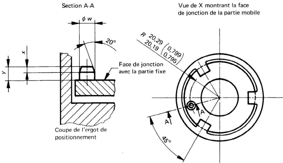
FIGURE 2 -- Espace à laisser libre et détail de branchement du raccord
