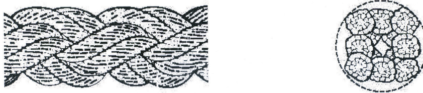
Figure 2 — Forme d'un cordage tressé à 8 torons (type L)
