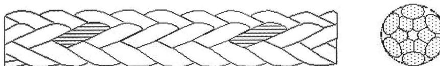
Figure 4 — Forme d'un cordage tressé à 12 torons (type T)
