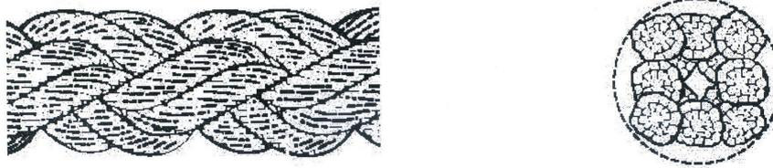
Figure 3 — Forme d'un cordage tressé à 8 torons (type L)
