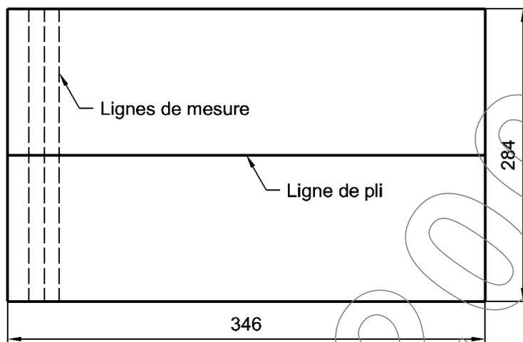
**Figure B.2 — Zone de mesure de l'étalon de plis**
