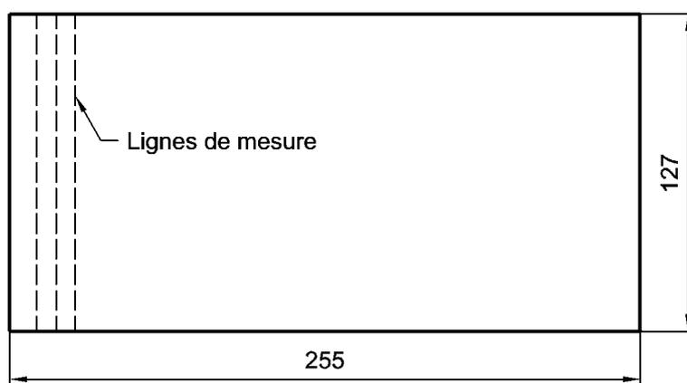
Figure B.2 — Zone de mesure de l'étalon de froissage
