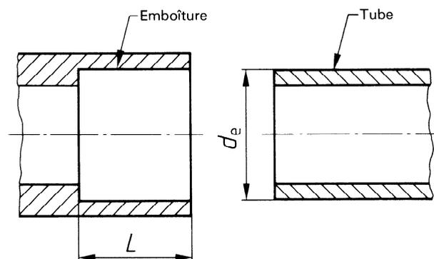
Figure — Dimensions de l'emboîture
