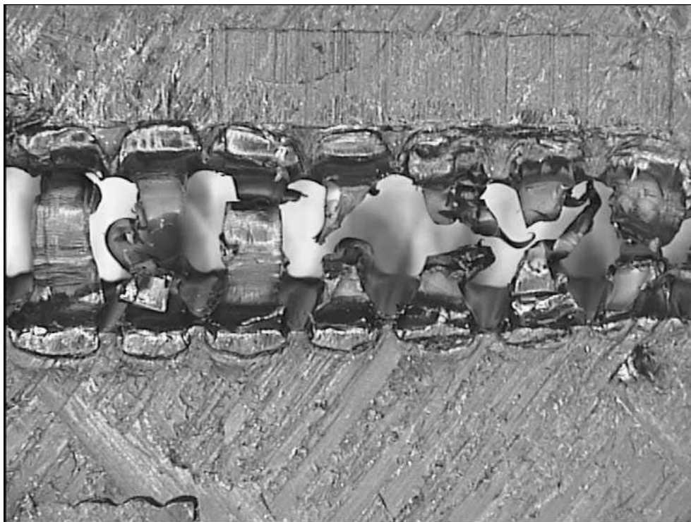
Рисунок 6 — Типичное пластическое разрушение между проволоками – вид сбоку
