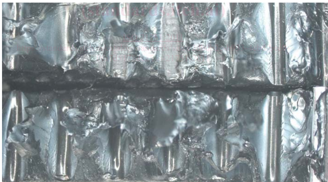
Рисунок 4 — Типичное хрупкое разрушение — вид сбоку
