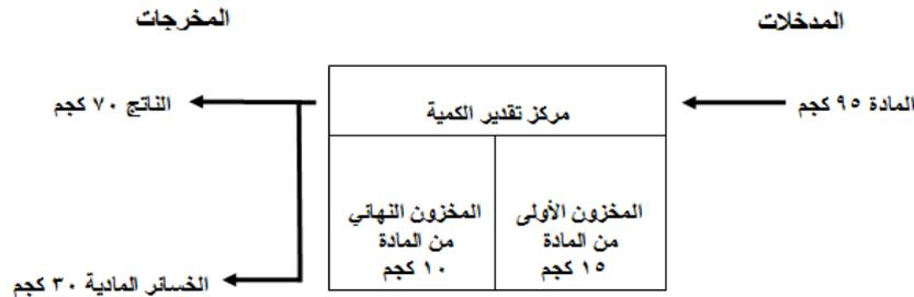
ملاحظة للتبسيط: يشمل هذا الشكل فقط على معلومات حول تدفقات المادة وليس استخدام الطاقة
