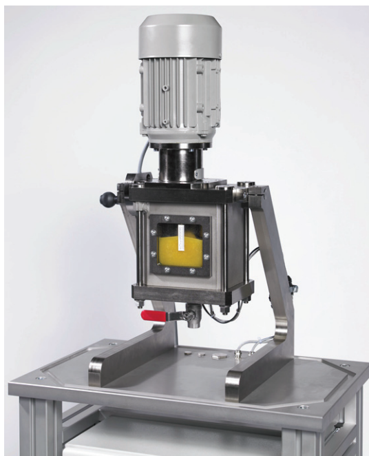
Figure 2 — Vue générale d'un dispositif d'essai de moussage
