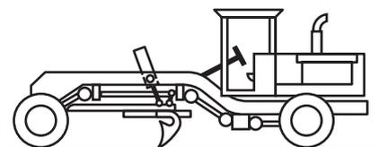
Figure 5 — Niveleuse avec moteur à l'arrière
