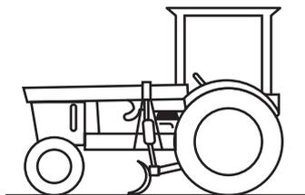
Figure 4 — Niveleuse avec moteur à l'avant
