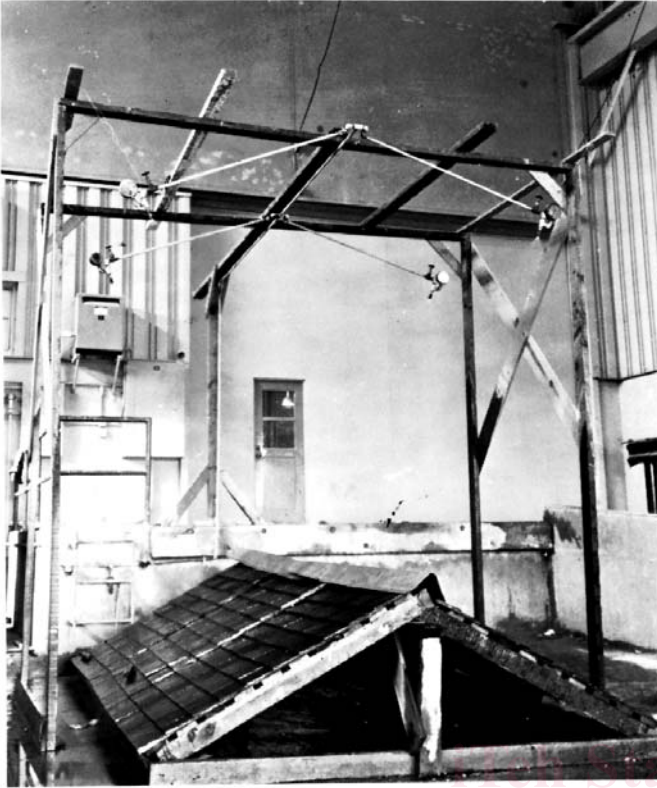
FIG. 3 Rain Test Apparatus
