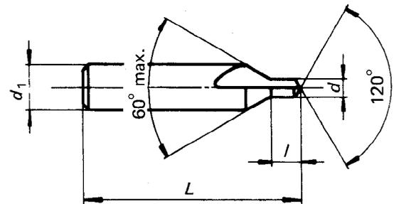
FIGURE 1 – Foret à centrer simple – Type A ( $d \leq 0,8$  mm)
