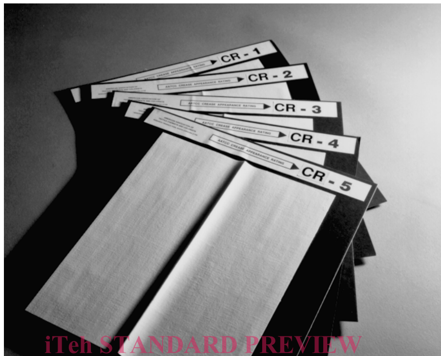
Figure 3 —Étalons de plis AATCC en matière plastique pour l'évaluation des plis
