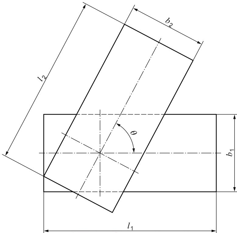
**Légende** $l_1, l_2$  longueur des coupons ( $\geq 60$  mm) $b_1, b_2$  largeur des coupons ( $\geq 40$  mm) $\theta$  angle de positionnement relatif entre les coupons avant essai
