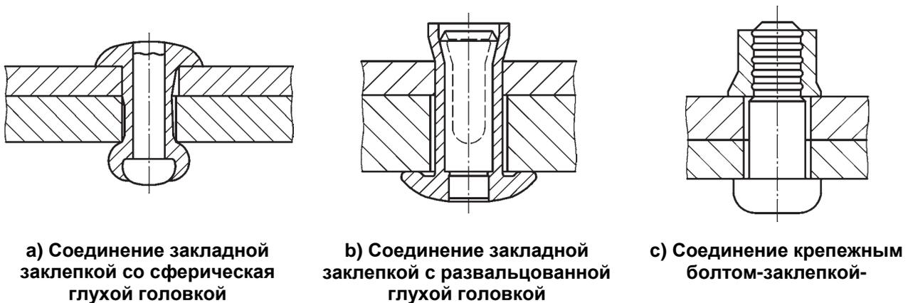
Рисунок 2—Примеры соединений со свободной посадкой, с прессовой глухой посадкой
