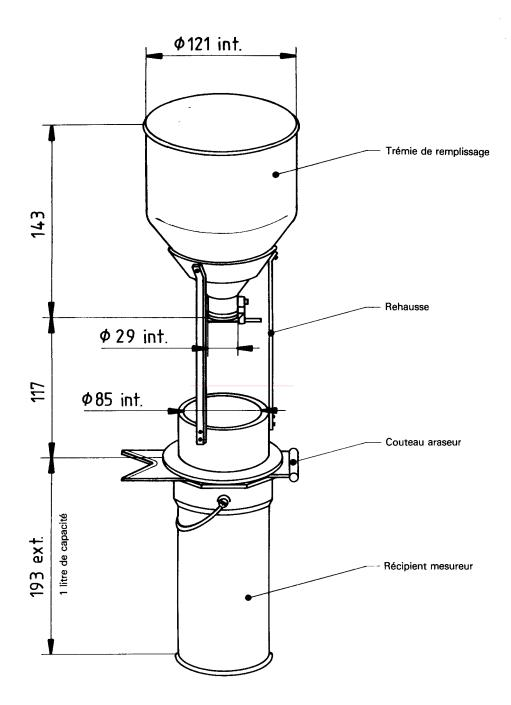
NOTE — La figure A.1 donne les cotes de l'appareillage de 1 l de capacité. Si l'on souhaite effectuer la détermination avec un échantillon réduit de moitié, on peut utiliser un appareil dont les dimensions sont également réduites dans les mêmes proportions, mais ceci uniquement sous la responsabilité de l'opérateur. Seule la méthode avec 1 l est la méthode de référence.
