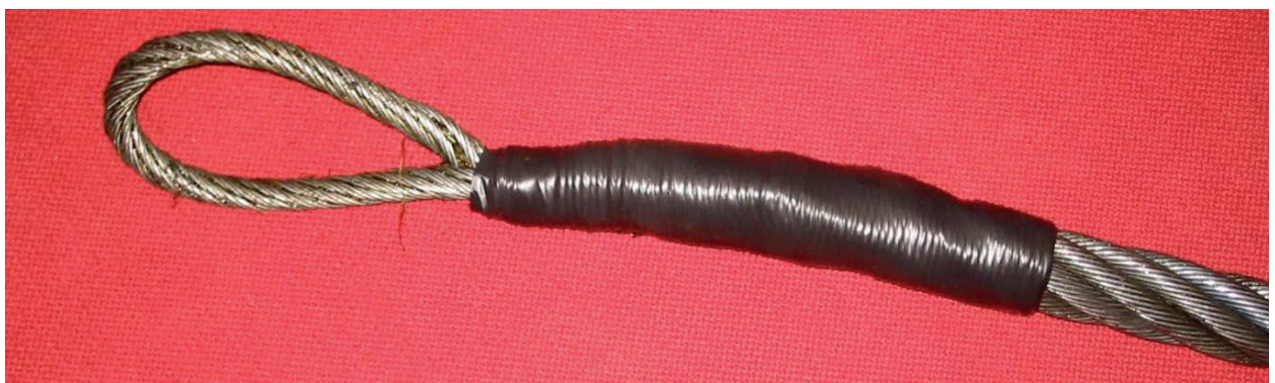
Figure 2 — Œil de tirage flexible achevé réalisé à partir de l'âme d'acier elle-même
