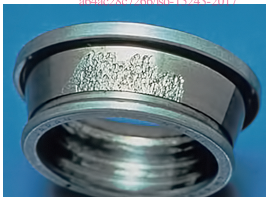
Figure 4 — Écaillage avancé en sous-couche dans un roulement à rouleaux coniques — Bague intérieure fixe
