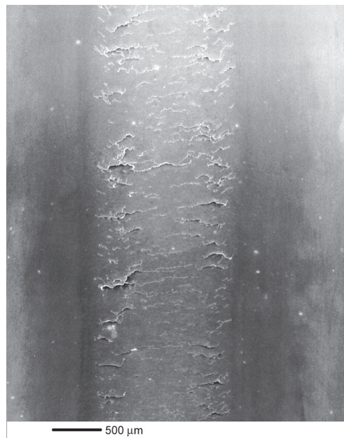
Figure 7 — Zones micro-écaillées sur un chemin de roulement
