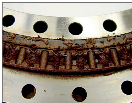
Figure 14 — Corrosion due à l'humidité sur la cage et les rouleaux d'une butée à aiguilles
