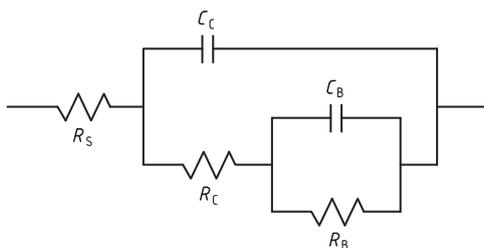
Figure 5 — Circuit équivalent de Randles étendu
