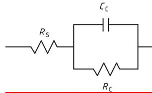
Figure 3 — Circuit équivalent de Randles
