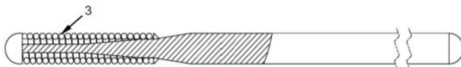
e) Guide mandrin avec chemise en polymère distale
