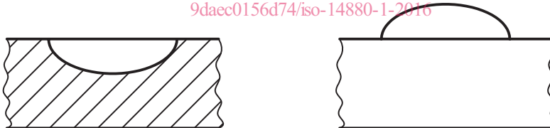
b) Microlentille réfractive à relief de surface
