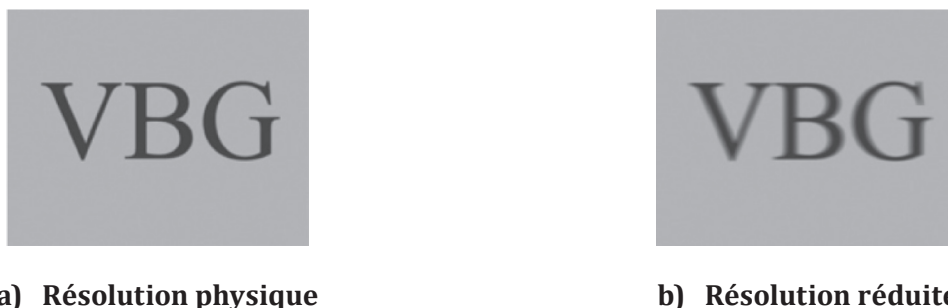
Figure 1 — Comparaison de lettres affichées avec une résolution physique et une résolution réduite
