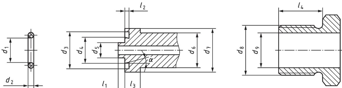
Figure 18 — Raccord d'évacuation du gaz pour une pression de 500 bar — Composants
