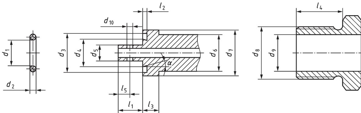
Figure 16 — Raccord de remplissage pour une pression de 500 bar — Composants
