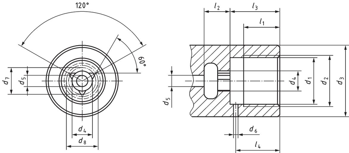
Figure 14 — Sortie de robinets pour une pression de 500 bar
