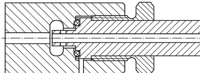
Figure 15 — Raccord de remplissage pour une pression de 500 bar — Schéma d'assemblage
