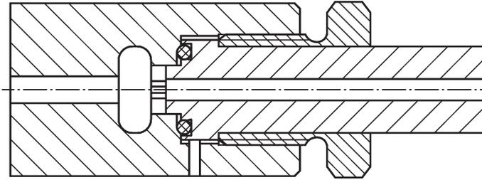
Figure 17 — Raccord d'évacuation du gaz pour une pression de 500 bar — Schéma d'assemblage
