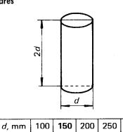
Un cylindre ayant une section de chargement de 10 000 mm<sup>2</sup> est également admissible; il est désigné sous la dénomination de «cylindre de diamètre nominal 100 mm».
