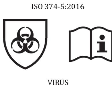
**Figure 3 — Marquage des gants protégeant contre les virus, les bactéries et les moisissures**
