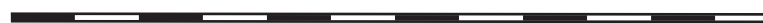
Figure 3 — Deux traits continus fins tangents de part et d'autre d'un trait épais interrompu
