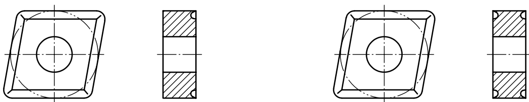
b) CN.N avec brise-copeaux sur une seule face c) CN.G avec brise-copeaux sur les deux faces
