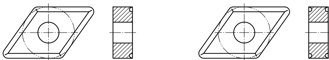
b) DN.M avec brise-copeaux sur une seule face c) DN.G avec brise-copeaux sur les deux faces
