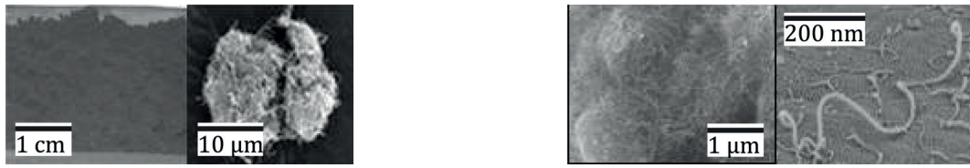
a) Résolution à l'échelle macroscopique (agrégats) b) Résolution à l'échelle mésoscopique (MWCNT individuel)
