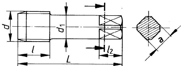
Tableau 1 – Tarauds pour filetage cylindrique – Séries G et Rp
