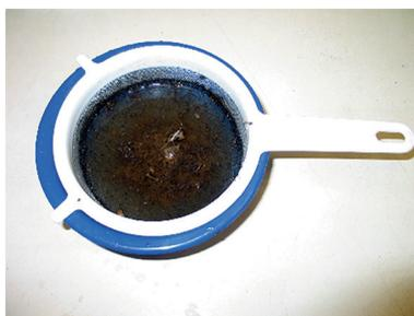
Figure 1 — Bol d'extraction avec échantillon de sol
