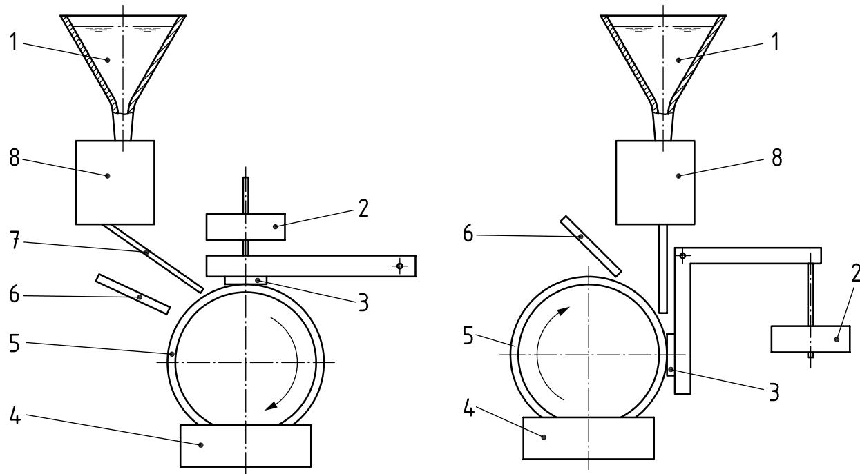
a) Avec une pièce d'essai horizontale
