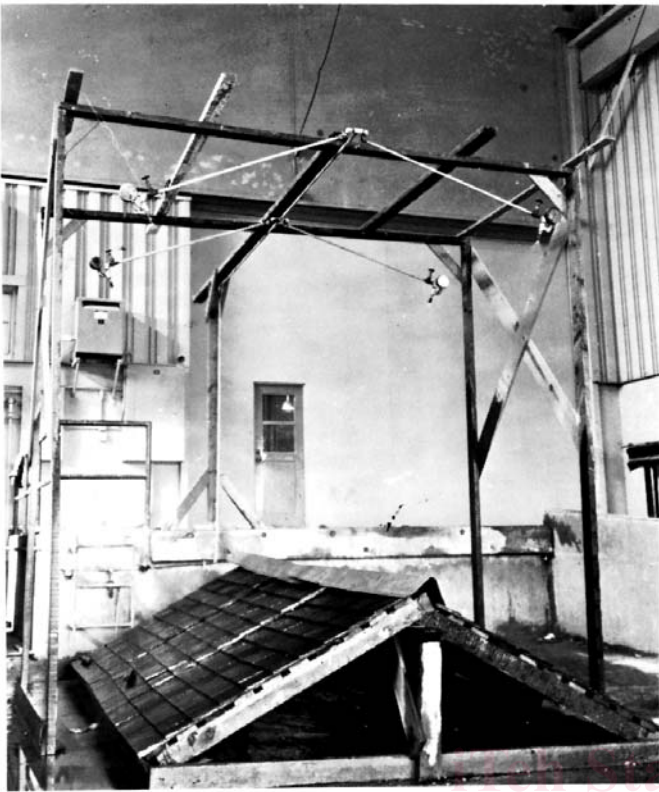
FIG. 3 Rain Test Apparatus
