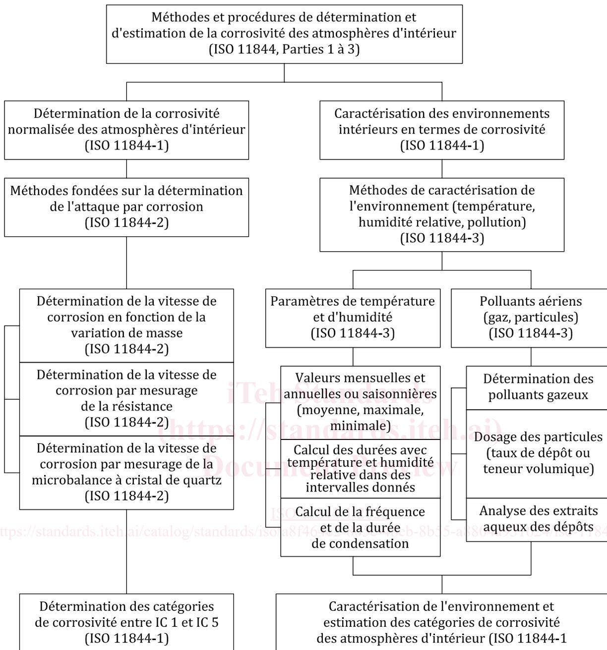
Figure 1 — Diagramme de classification de la faible corrosivité des atmosphères d'intérieur
