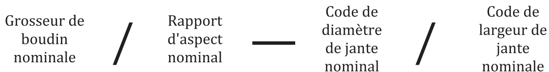
Figure 1 — Indication des caractéristiques dimensionnelles et de construction
