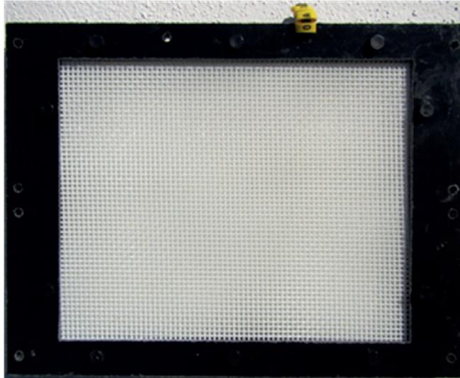
**Figure 1 — Éprouvette de film recouverte d'une grille en plastique non dégradable et fixée entre deux châssis en plastique non dégradable**
