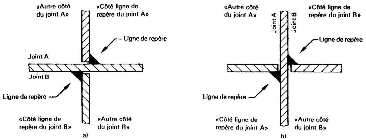
Figure 3 — Assemblage en croix avec deux soudure d'angle
